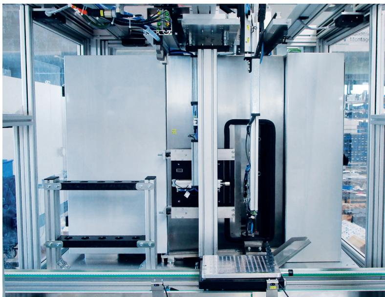
Optische Prüfanlage für innenliegende Kühlkanäle an Bohrer und Fräser
